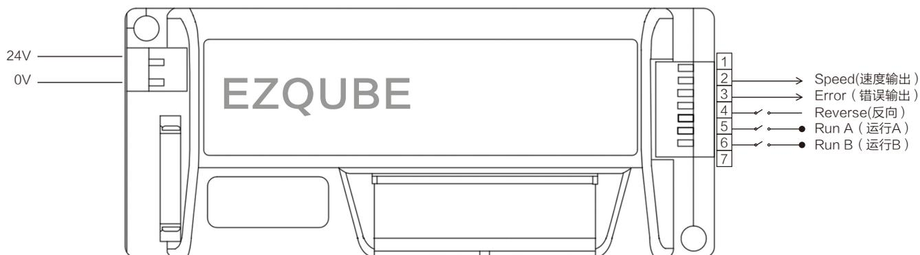
通电之前，请先确定驱动卡电源正负极是否连接正确。
